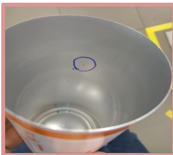
Figura 8: Metal Exposto na parede alta da lata
